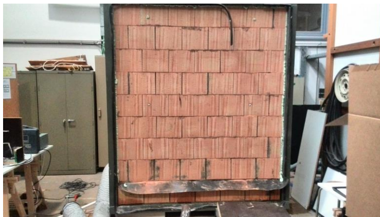
Binnenspouwblad na watertest tot maximale toetsingsdruk van 450 Pa
