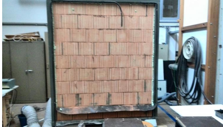
Figuur 2: Opstelling na waterstroom 60 s doorlaten en 540 s tegenhouden gedurende 96 uur
